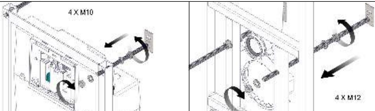
2. Установить раму по уровню и размерам (см. п. 8), регулировать с помощью гаек с внешней стороны, выставить раму, затянуть гайки с внутренней стороны (п. 9, поз. 18, 7), затянуть винты установочные (п. 9, поз. 13), усилие затяжки не более 10 Н·м, разметить отверстия.
